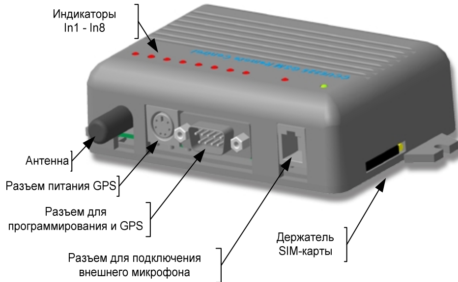
Рисунок 2. CCU6225 – основные элементы
